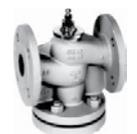
**Клапан регулирующий двухходовой G2FM-T для ВОДЫ высокопрочный чугун (GGG 40) фланцевый, Ру=16 бар (Ду 200-300 мм) Ру=10 (Ду 300-600 мм), Tmax=250 °С; управляется электроприводами серии VB-300**
